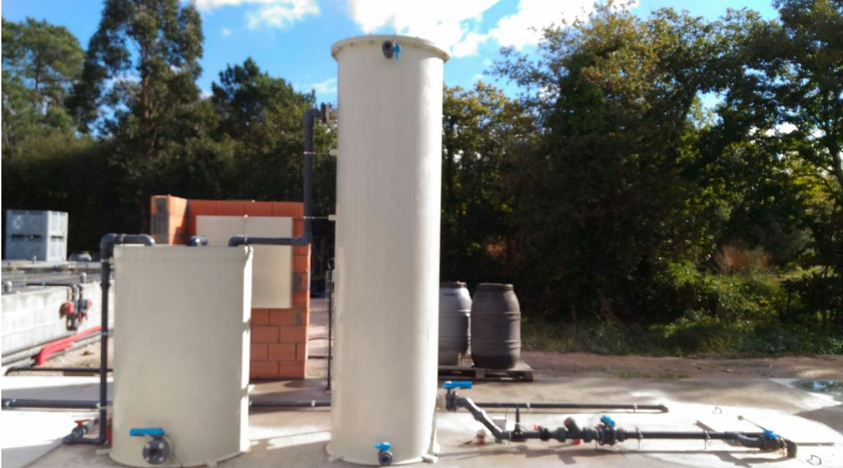
*Foto 1: Digestor anaerobio HUSB y pozo bombeo*
